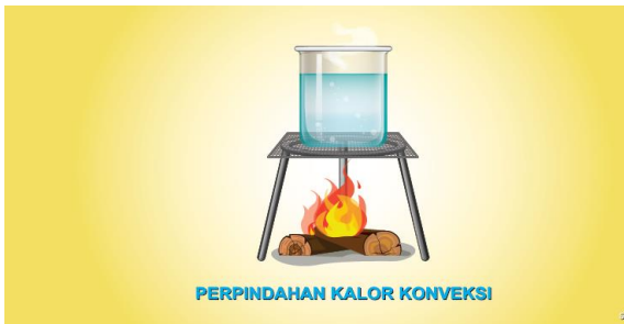
Gambar 2.17 Proses perpindahan panas secara konveksi
