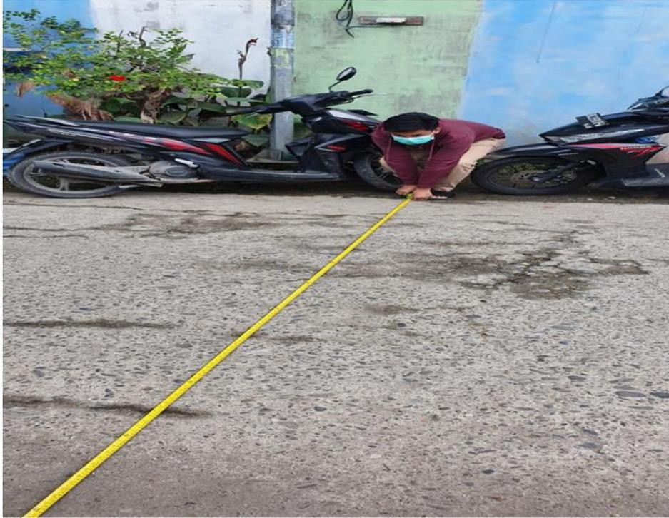
Gambar : Mengukur lebar jalan
