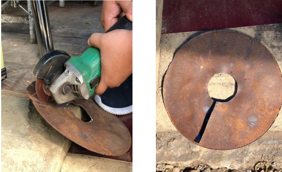
Gambar 4.15 Pemotongan Satu Sisi Pada Plat Lingkaran.
