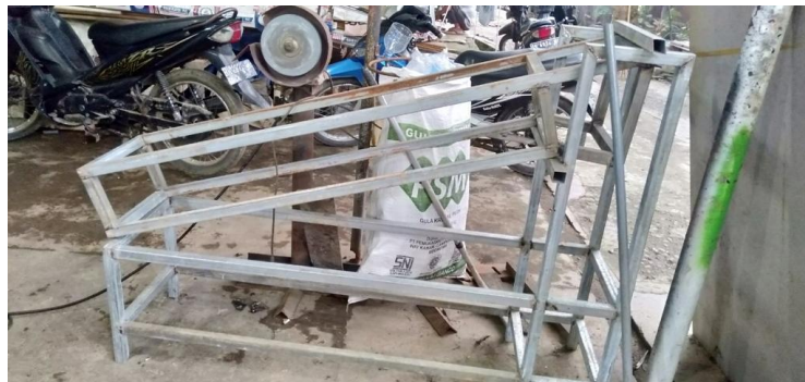
Gambar 4.37 Hasil Pembuatan Rangka Turbin Screw
