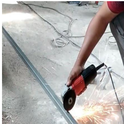
Gambar 4.33 Pemotongan Besi Hollow
