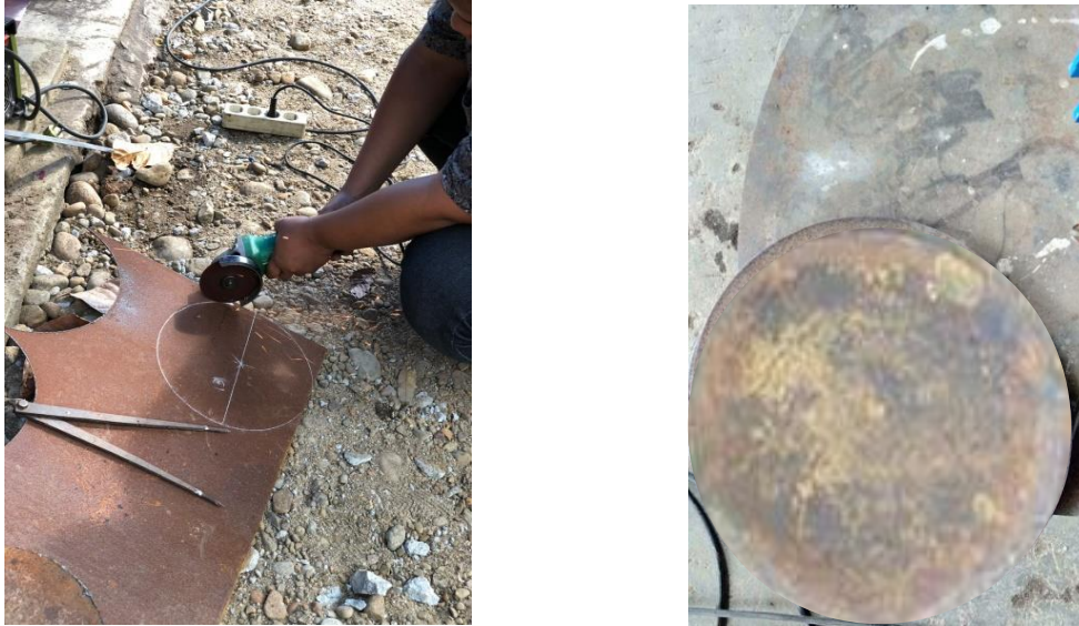
Gambar 4.13 Pemotongan Plat dan Plat Yang Telah Terpotong
