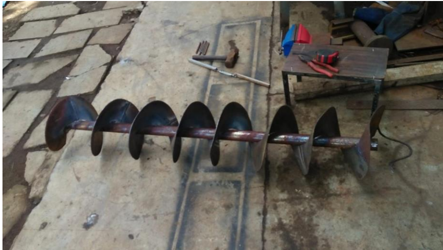
Gambar 4.23 Hasil Pembuatan Screw Pada Turbin Screw
