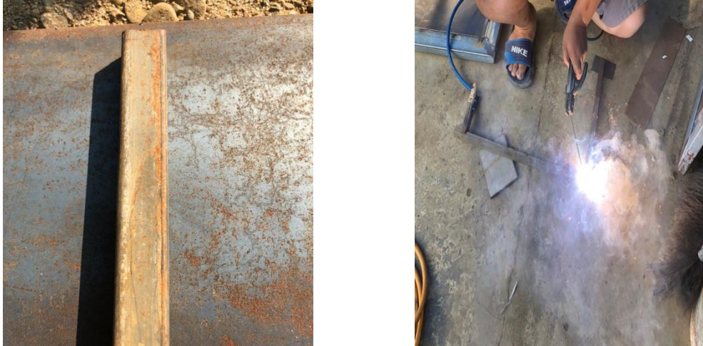
Gambar 3.38 Pembuatan Rangka Turbin Screw
