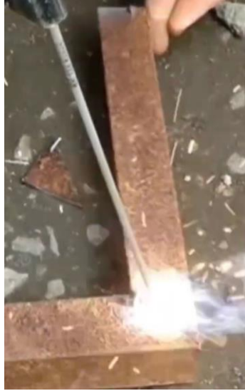
Gambar 4.43 Penyambungan Dudukan Pillowblock Bearing
