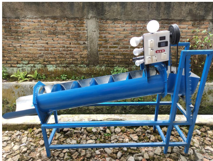
Gambar 4.54 Hasil pembuatan. Turbin Screw Untuk Pembangkit Listrik Tenaga Air Skala Laboratorium
