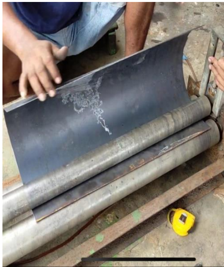
Gambar 4.25 Membentuk Plat Besi Menggunakan Mesin Roll
