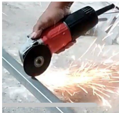
Gambar 4.42 Pemotongan Plat Siku
