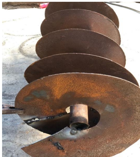
Gambar 4.20 Memasukkan Poros Pada Bagian Screw.
