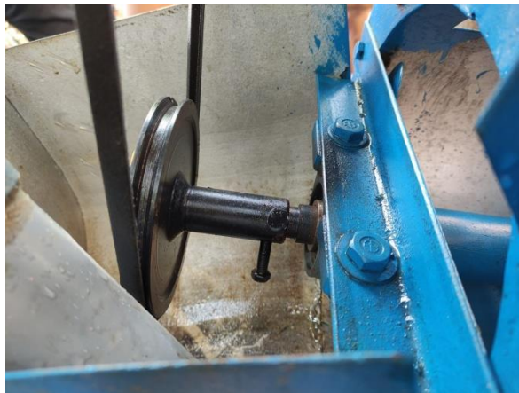
Gambar 4.51 Penyatuan Pulley Dengan Pillowblock Bearing
