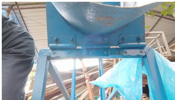
Gambar 4.49 Penyatuan Rangka dengan Rumah turbin
