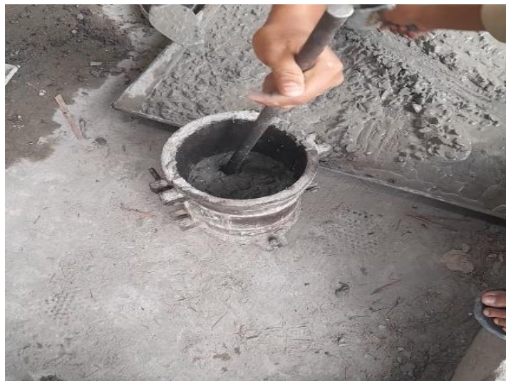
Gambar L-18 Perojokan Adukan Beton
