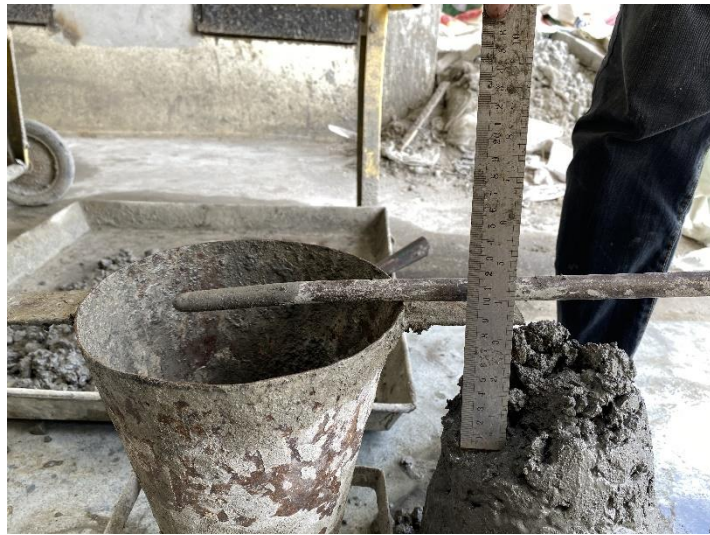
Gambar L-17 Proses Pengujian Slump Test
