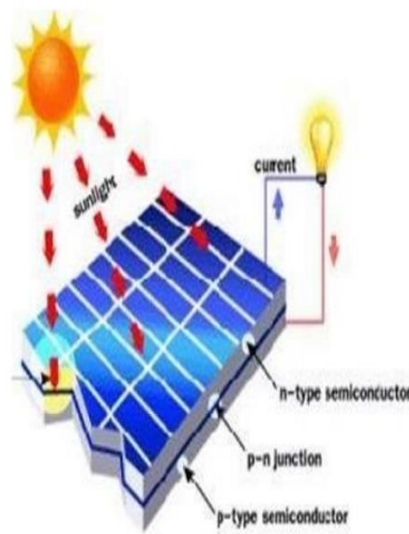
Gambar 2.1. Ilustrai Prinsip Kerja Solar Cell (Sumber : Pasaribu & Reza, 2021)
