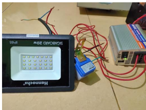
Gambar 4.3 Sensor Photocell Waktu Siang Hari
