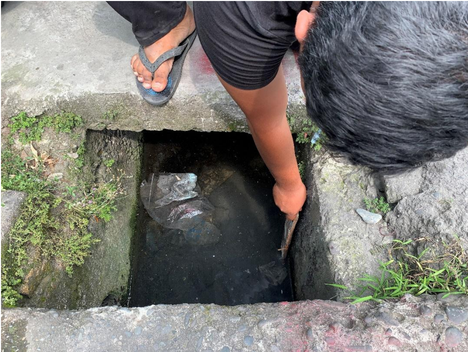
Foto 6. Mengukur Elevasi Hilir
