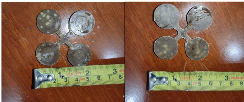
Gambar 4. 26 Hasil pengujian pertama suhu 200°C
