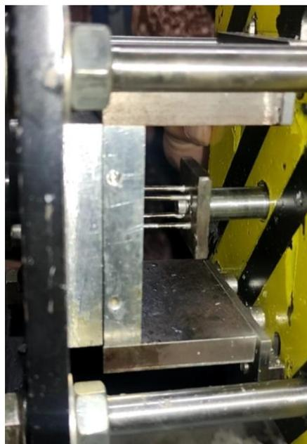
Gambar 3. 25 Plastik yang sudah masuk penuh kedalam  *mold*
