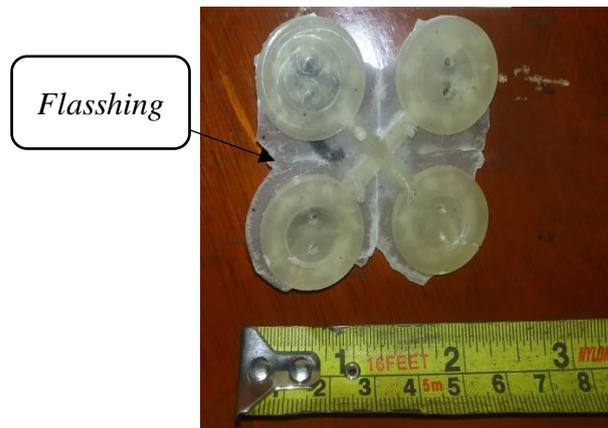
Gambar 4. 23 Hasil pengujian ketiga suhu 190°C
