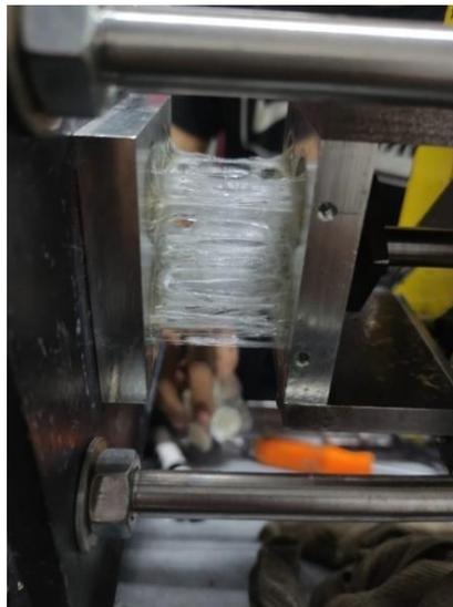
Gambar 4. 9 Pengujian pendinginan 3 menit 30 detik
