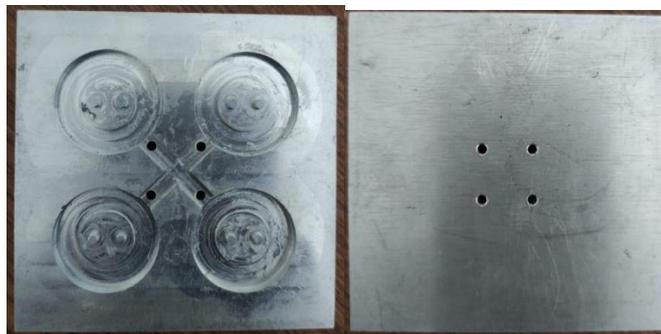
Gambar 3. 3 Cetakan Bergerak ( *Moving Mold* )
