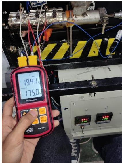
Gambar 3. 21 Mengukur kembali suhu heater dengan *thermometer digital*
