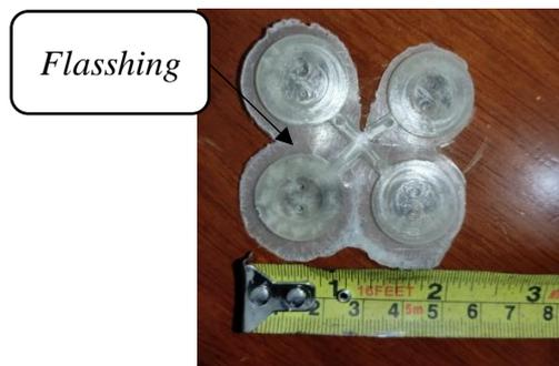
Gambar 4. 22 Hasil pengujian kedua suhu 190°C
