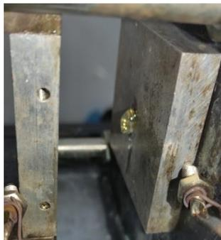
Gambar 4. 3 Cairan plastik yang keluar dari  *mold*  diam
