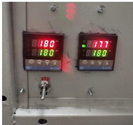
Gambar 3. 19 penyetelan suhu pada *PID*
