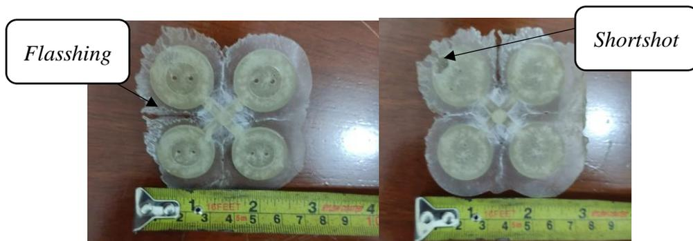
Gambar 4. 16 Hasil pengujian pertama suhu 180°C
