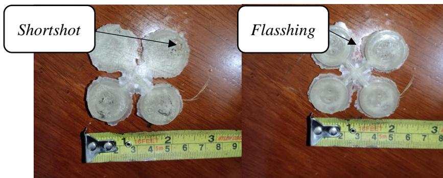
Gambar 4. 18 Hasil pengujian ketiga suhu 180°C
