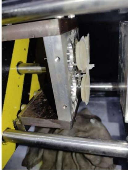
Gambar 3. 26 Hasil cetakan yang terdorong oleh *ejector pin*
