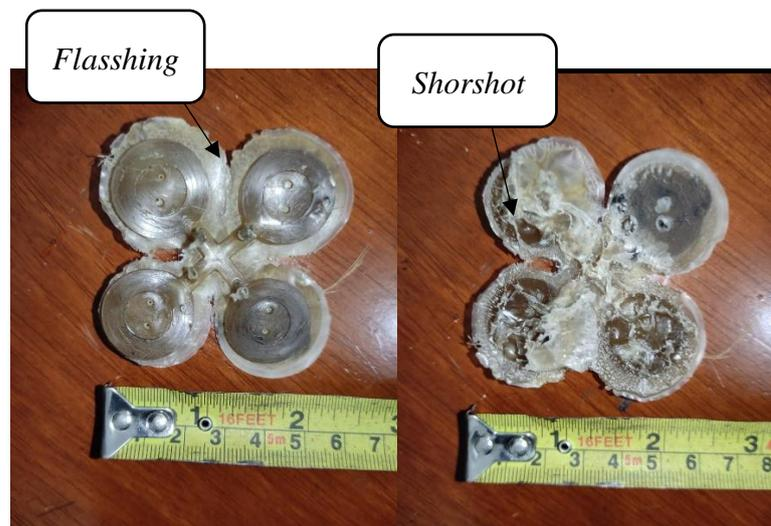
Gambar 4. 28 Hasil pengujian ketiga suhu 200°C
