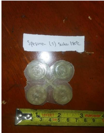
Gambar 4. 29 Hasil pengujian kedua suhu 170°C
