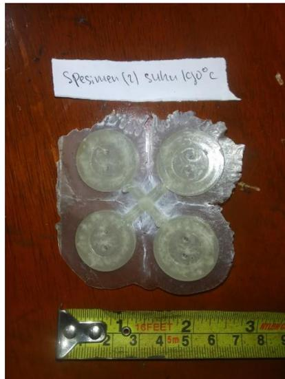
Gambar 4. 47 Hasil pengujian kedua suhu 190°C
