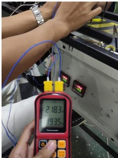
Gambar 4. 43 Perbandingan suhu antara heater 3 dan silinder dengan PID
