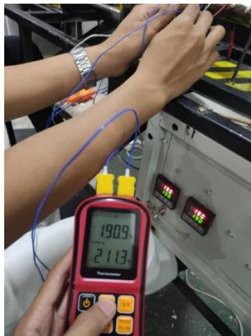
Gambar 4. 45 Perbandingan suhu antara heater 1 dan 2 dengan PID
