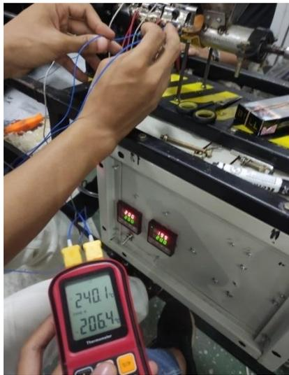
Gambar 4. 52 Perbandingan suhu antara heater 3 dan silinder dengan PID
