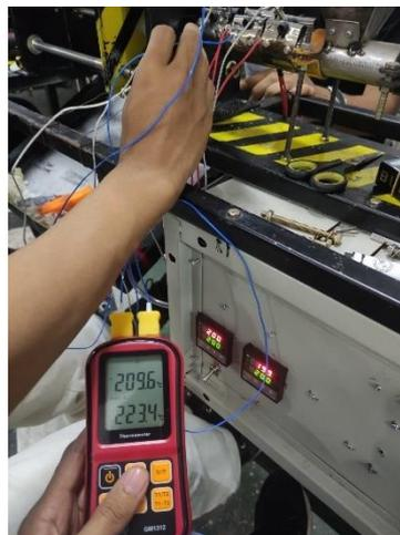
Gambar 4. 57 Perbandingan suhu antara heater 1 dan 2 dengan PID
