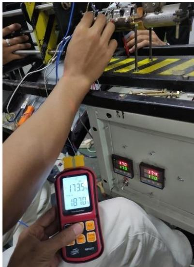
Gambar 4. 27 Perbandingan suhu antara heater 1 dan 2 dengan PID
