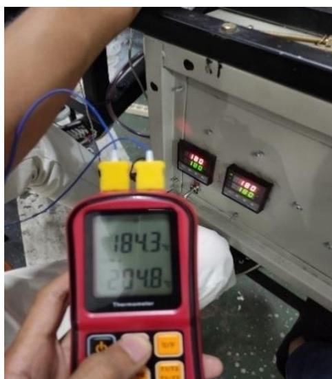
Gambar 4. 39 Perbandingan suhu antara heater 1 dan 2 dengan PID
