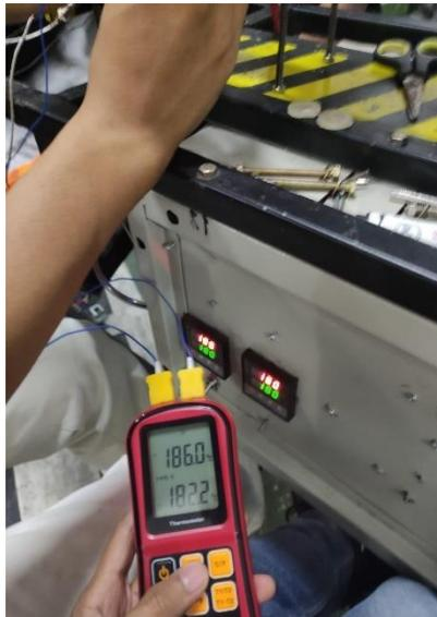
Gambar 4. 34 Perbandingan suhu antara heater 3 dan silinder dengan PID
