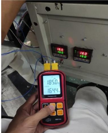
Gambar 4. 22 Perbandingan suhu antara *heater* 3 dan silinder dengan *PID*
