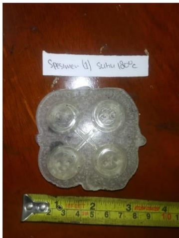
Gambar 4. 35 Hasil pengujian pertama suhu 180°C
