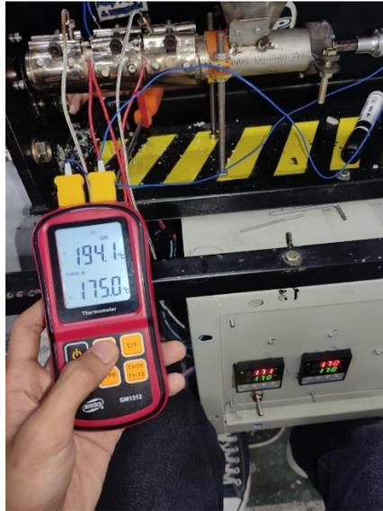
Gambar 3.23 Mengukur kembali suhu heater menggunakan thermometer digital
