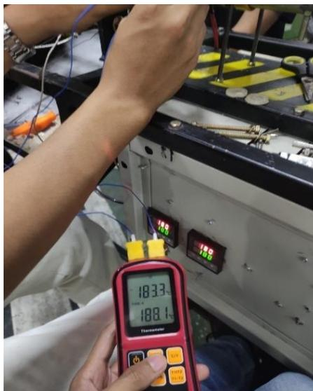
Gambar 4. 37 Perbandingan suhu antara heater 3 dan silinder dengan PID
