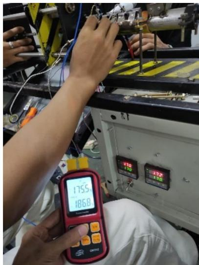
Gambar 4. 30 Perbandingan suhu antara heater 1 dan 2 dengan PID
