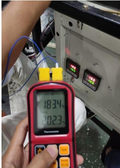
Gambar 4. 33 Perbandingan suhu antara heater 1 dan 2 dengan PID
