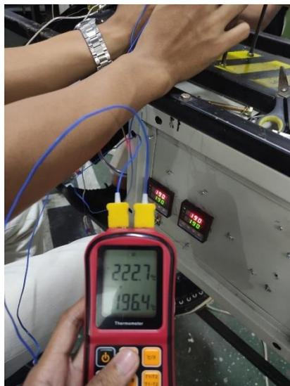
Gambar 4. 46 Perbandingan suhu antara heater 3 dan silinder dengan PID
