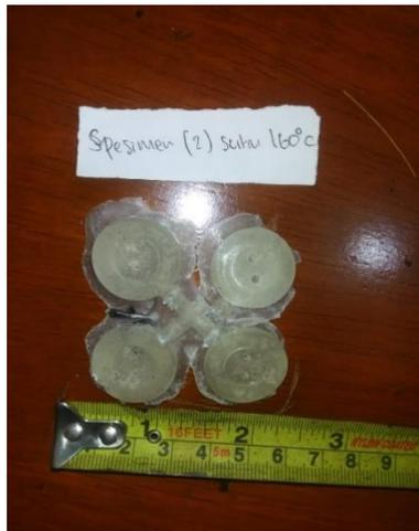
Gambar 4. 20 Hasil pengujian kedua suhu 160°C
