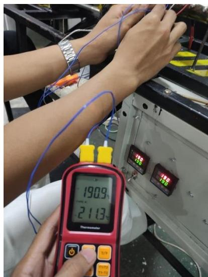
Gambar 4. 48 Perbandingan suhu antara heater 1 dan 2 dengan PID
