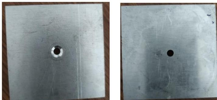
Gambar 3. 4 *Cetakan Diam ( Stationary Mold )*
