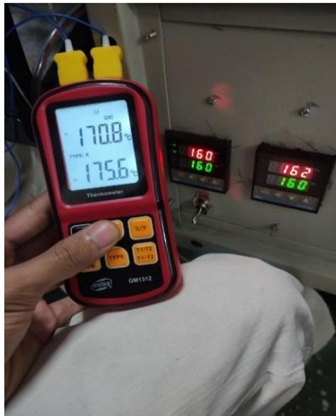
Gambar 4. 21 Perbandingan suhu antara heater 1 dan 2 dengan PID
