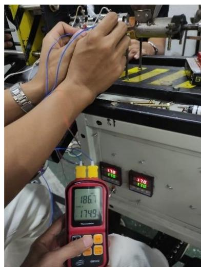
Gambar 4. 28 Perbandingan suhu antara heater 3 dan silinder dengan PID
