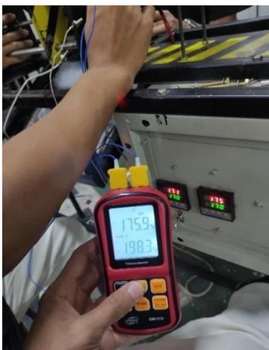
Gambar 4. 24 Perbandingan suhu antara heater 1 dan 2 dengan PID
