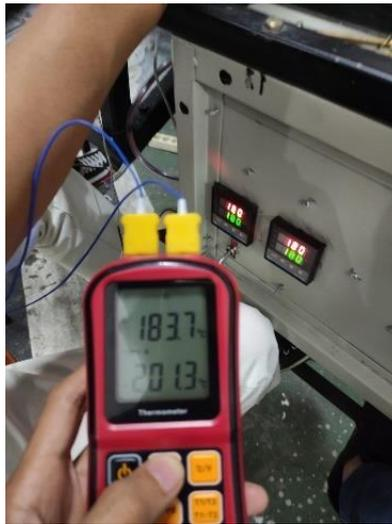
Gambar 4. 36 Perbandingan suhu antara heater 1 dan 2 dengan PID
