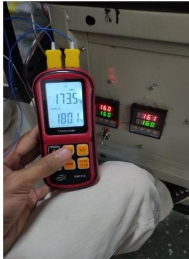
Gambar 4. 18 Perbandingan suhu antara heater 1 dan 2 dengan PID
