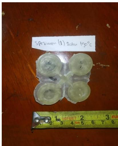
Gambar 4. 44 Hasil pengujian pertama suhu 190°C
