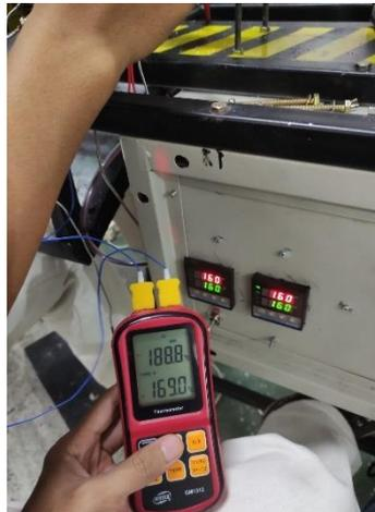
Gambar 4. 16 Perbandingan suhu antara heater 3 dan silinder dengan PID
