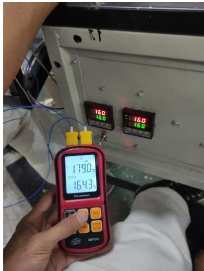
Gambar 4. 19 Perbandingan suhu antara heater 3 dan silinder dengan PID
