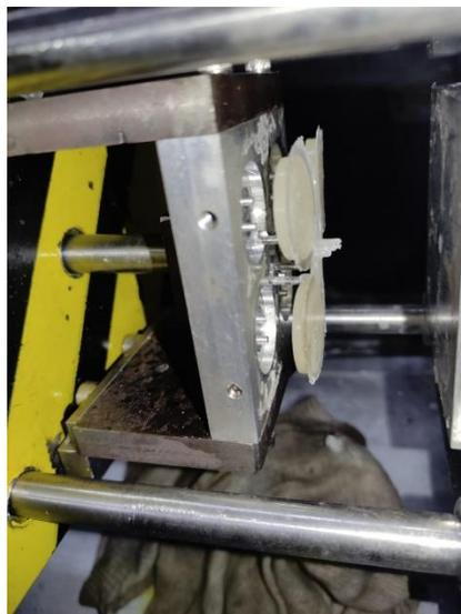
Gambar 3.28 Hasil cetakan yang terdorong oleh  *ejector pin*
