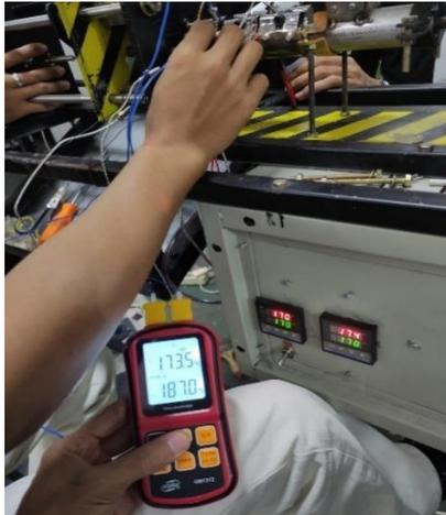
Gambar 4. 31 Perbandingan suhu antara heater 3 dan silinder dengan PID
