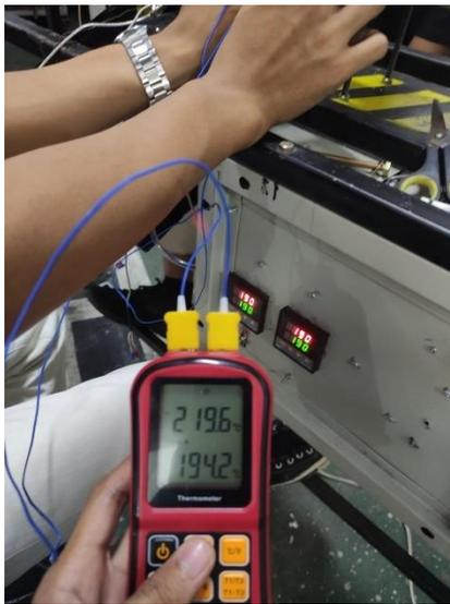
Gambar 4. 49 Perbandingan suhu antara heater 3 dan silinder dengan PID
