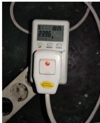
Gambar 3.20 Pemasangan watt meter dengan mesin *injection molding* lalu menghubungkan kepada sumber daya
