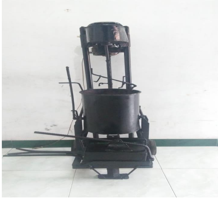
Gambar 3.5 Alat Pembuat Paving block
