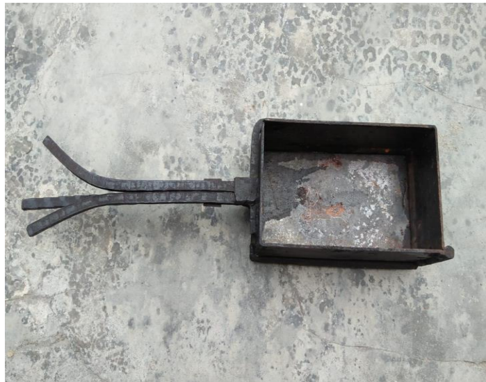
Gambar 3.6 Cetakan Paving Block
