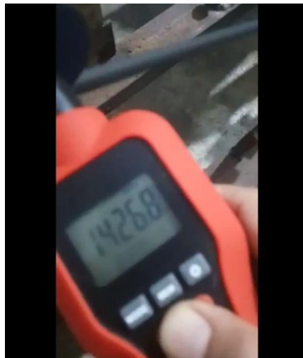
Gambar 4.27 Rpm penggerak awal (motor induksi) pada roda gaya 32 Kg
