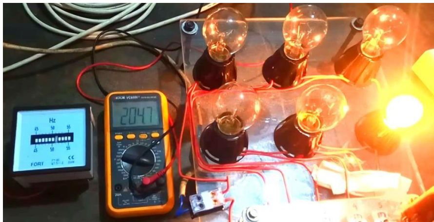
Gambar 4.13 Tegangan keluaran dan Frekuensi Generator pada Beban Lampu Pijar 5 watt
