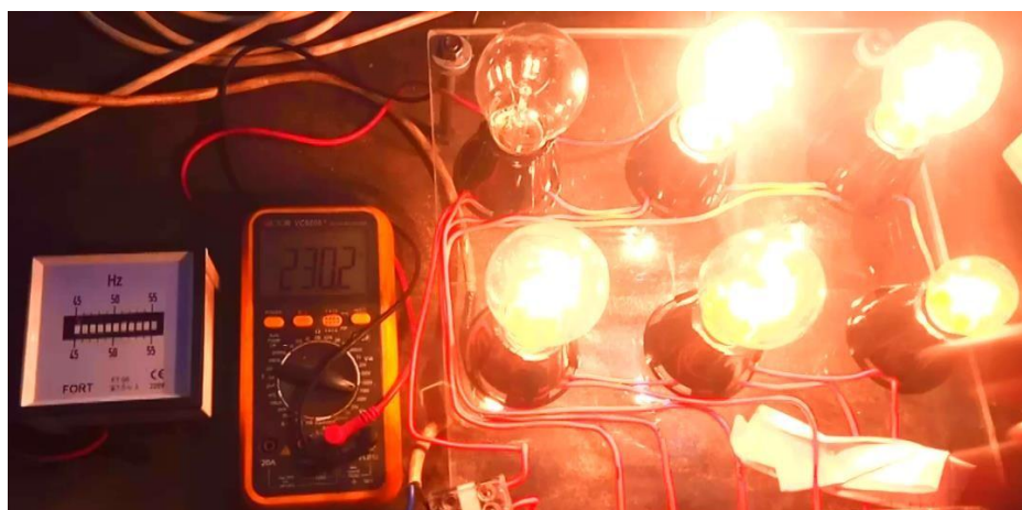
Gambar 4.22 Tegangan keluaran dan Frekuensi Generator pada Beban Lampu Pijar 5 watt, 15 watt, 25 watt, 40 watt, 60 watt (145 watt)
