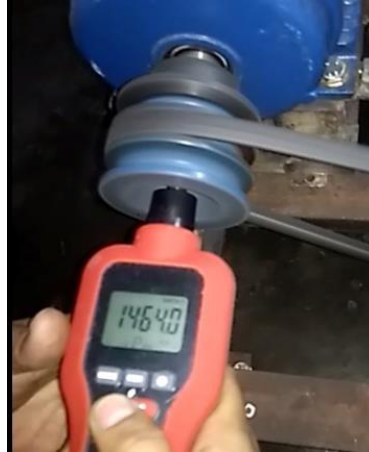
Gambar 4.3 Rpm penggerak awal (Motor Induksi) pada roda gaya 62 Kg
