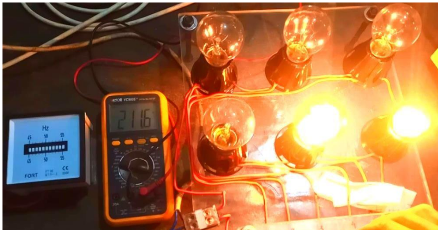
Gambar 4.15 Tegangan keluaran dan Frekuensi Generator pada Beban Lampu Pijar 5 watt dan 15 watt (20Watt)
