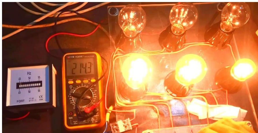
Gambar 4.18 Tegangan keluaran dan Frekuensi Generator pada Beban Lampu Pijar 5 watt, 15 watt, 25 watt (45 watt)
