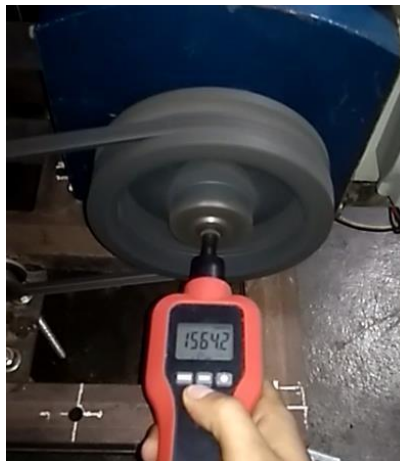
Gambar 4.4 Rpm Generator Induksi pada roda gaya 62 Kg
