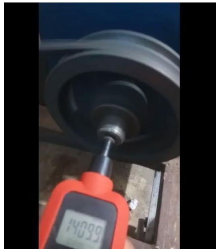
Gambar 4.28 Rpm generator induksi pada roda gaya 32 Kg
