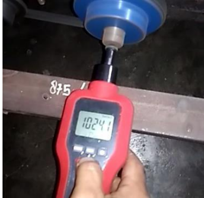
Gambar 4.5 Rpm pada Transmisi 1 roda gaya 62 Kg
