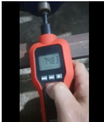
Gambar 4.29 Rpm pada transmisi 1 roda gaya 32 Kg
