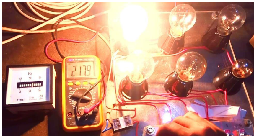
Gambar 4.21 Tegangan keluaran dan Frekuensi Generator pada Beban Lampu Pijar 100 watt
