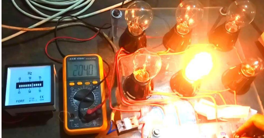
Gambar 4.14 Tegangan keluaran dan Frekuensi Generator pada Beban Lampu Pijar 15 watt
