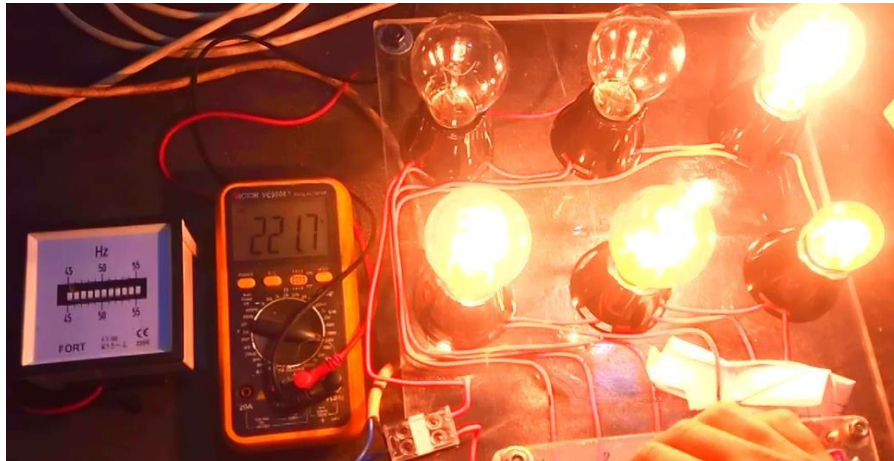
Gambar 4.20 Tegangan keluaran dan Frekuensi Generator pada Beban Lampu Pijar 5 watt, 15 watt, 25 watt, 40 watt (85 watt)
