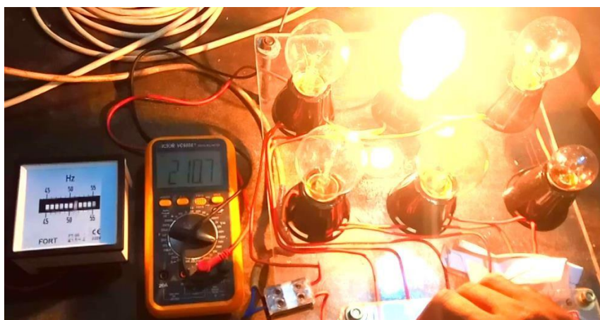
Gambar 4.19 Tegangan keluaran dan Frekuensi Generator pada Beban Lampu Pijar 60 watt
