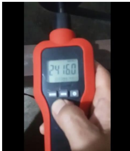
Gambar 4.30 Rpm pada transmisi 2 (roda gaya 32 Kg)
