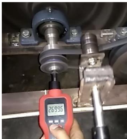
Gambar 4.6 Rpm pada Transmisi 2 (Roda Gaya 62 Kg)
