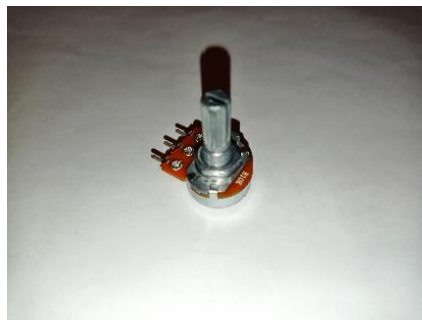
Gambar 4.4 Bentuk fisik potensiometer
