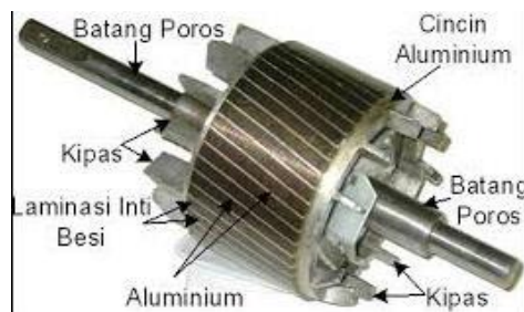
Gambar 2.6 Rotor Sangkar Tupai
