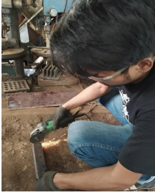
Gambar 4.4 Pemotongan Besi Hollow Dan Besi Baja
