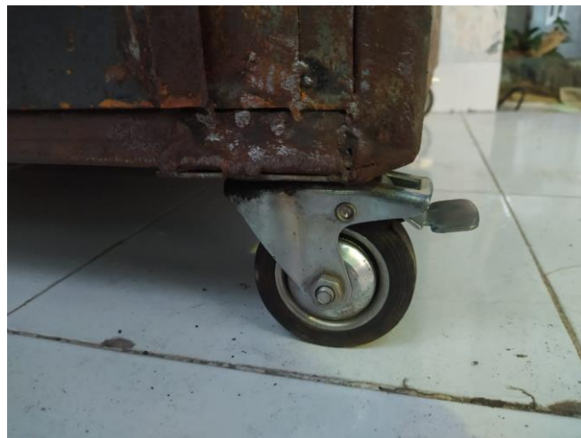
Gambar 4.14 Hasil Pemasangan Roda
