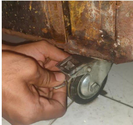
Gambar 4.18 Pemasangan Roda Nylon Caster
