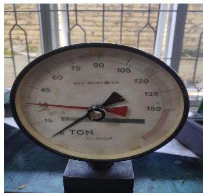
Gambar 4.18 Timbangan pada mesin uji tarik
