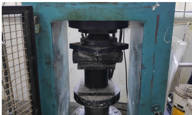
Gambar 4.20 hasil uji tekan spesimen dua (spesimen pecah)
