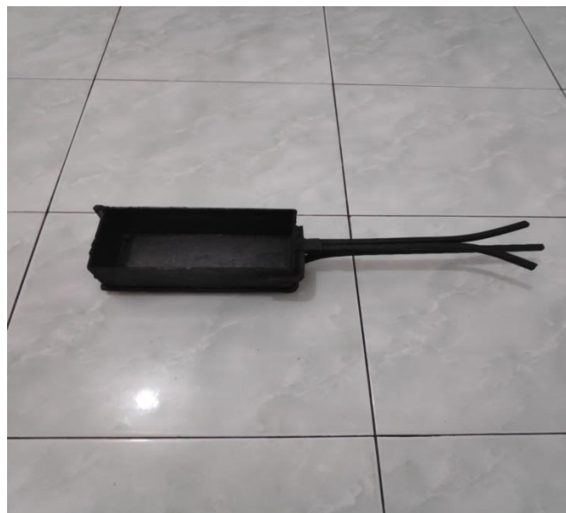
gambar 3.4 Cetakan paving block
