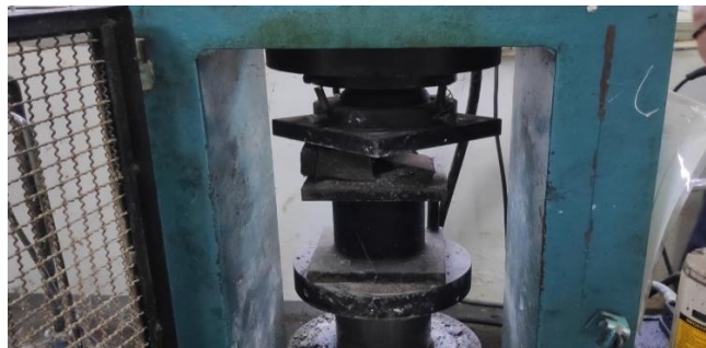
Gambar 4.19 Hasil uji tekan spesimen satu (spesimen pecah)
