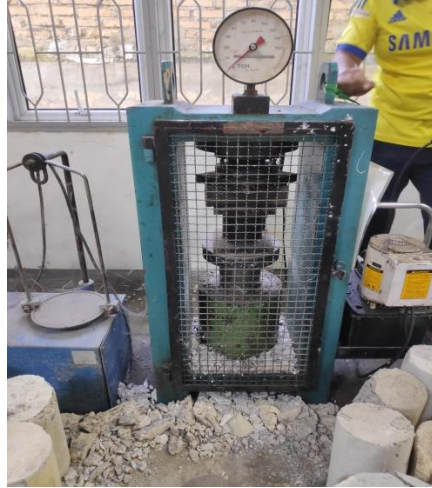
Gambar 4.16 Meletakkan spesimen uji pada mesin uji tekan
