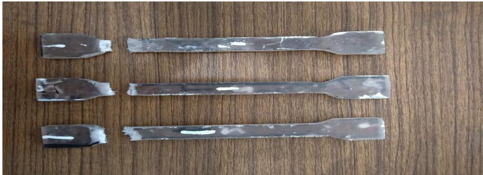
Gambar 4.1 Hasil Pengujian Tarik 70 % Resin : 30 % Fiberglass
