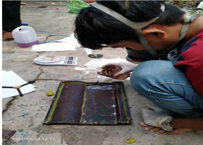
Gambar 3.42 Penuangan Resin Kedalam Cetakan Atap
