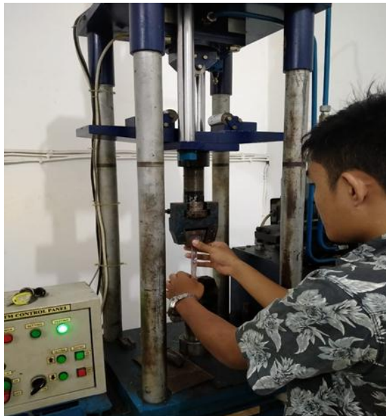
Gambar 3.50 Proses Pemasangan Spesimen Uji Tekan
