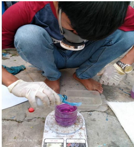
Gambar 3.41 Proses Pencampuran Katalis
