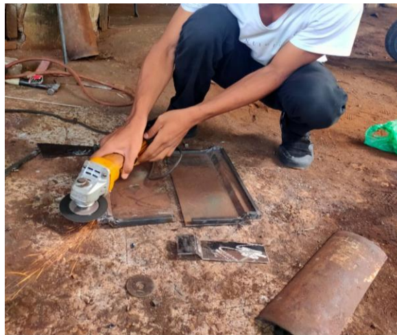
Gambar 3.34 Proses Pengalusan Permukaan
