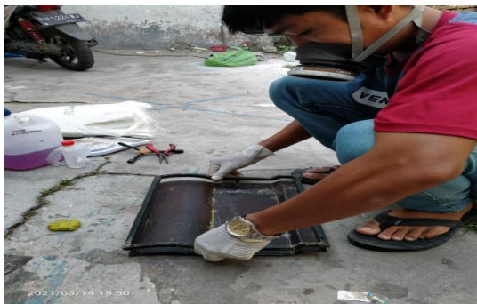
Gambar 3.38 Pemasangan Cetakan Tengah Atap
