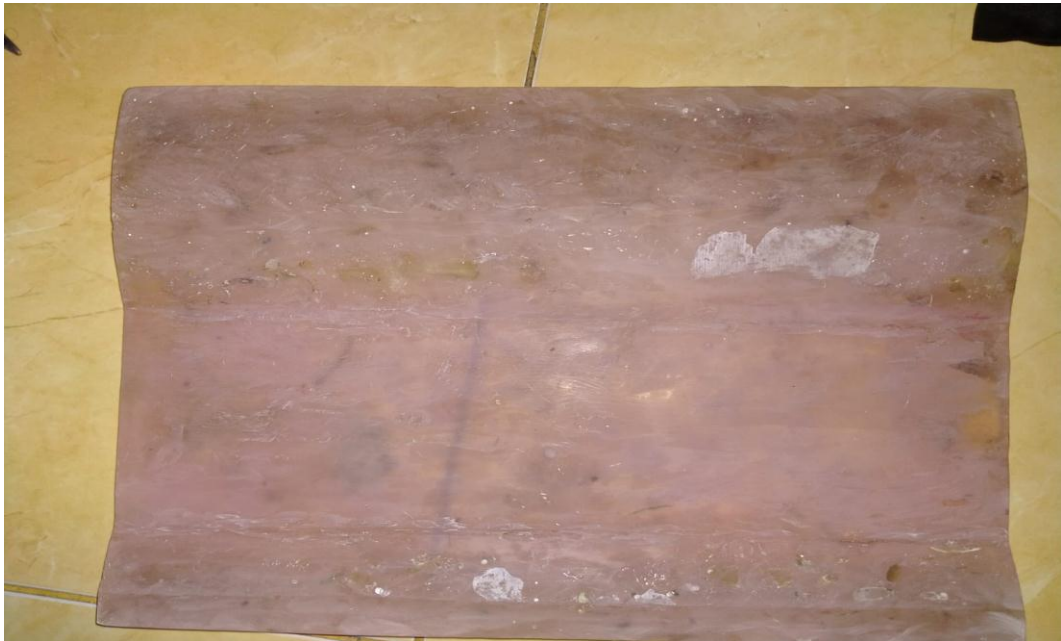
Gambar 4.21 Produk Atap Genteng berbahan komposit Serat Fiberglass
