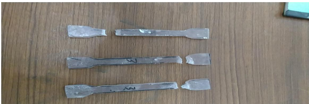
Gambar 4.3 Hasil Pengujian Tarik 75 % Resin : 25 % Fiberglass
