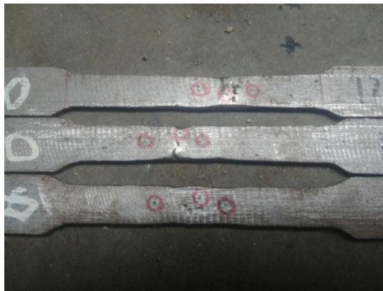
Gambar 4.22. Spesimen Hasil Uji Kekerasan
