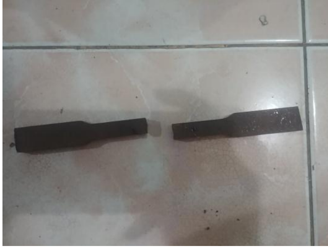
Gambar 4.5. Pemotongan Dua Bagian Spesimen
