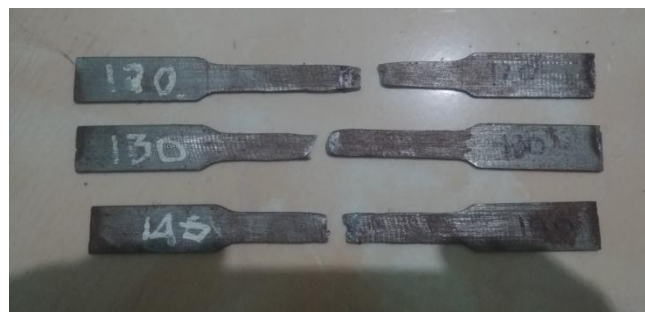
Gambar 4.19. Spesimen Benda Uji Tarik Yang Sudah Putus
