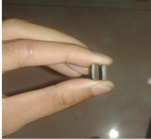
Gambar 4.20. Hasil Penetrasi Las Ampere Kecil
