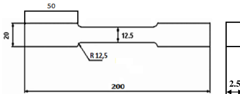
Gambar 4.12. Spesimen Standard ASTM E8
