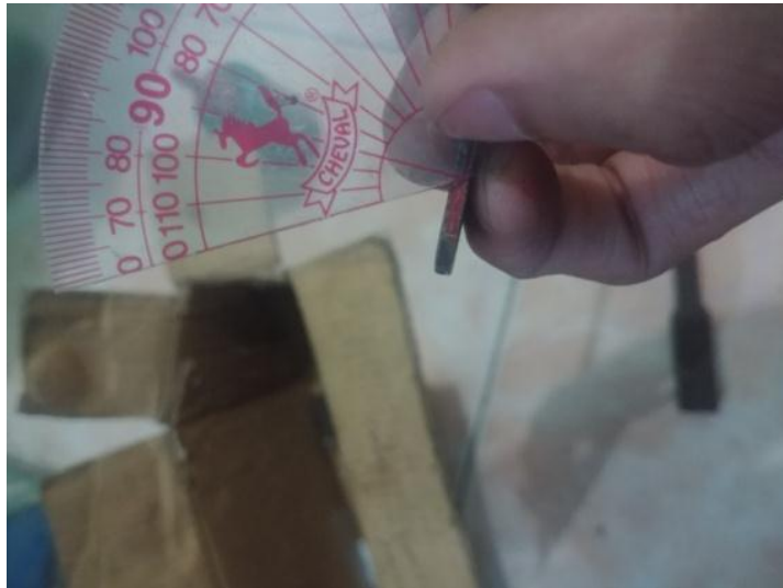
Gambar 4.6. Pembuatan Sudut Kampuh Spesimen
