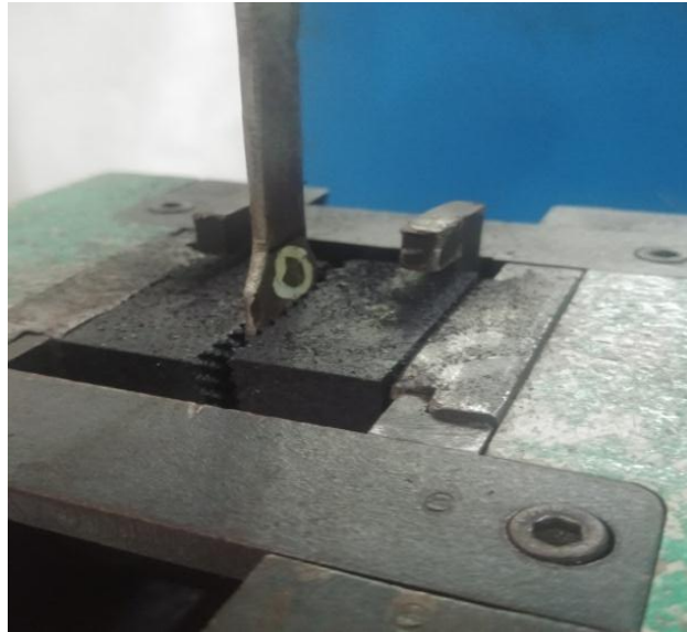
Gambar 4.15. Menjepit Spesimen Di Ragum
