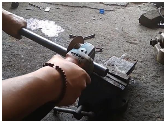
Gambar. 4.2. Pemotongan Pipa Besi
