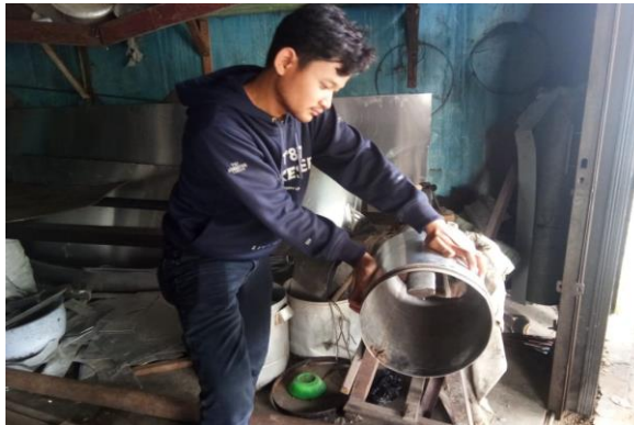
Gambar. 4.6. Proses Melengkungkan Sudu
