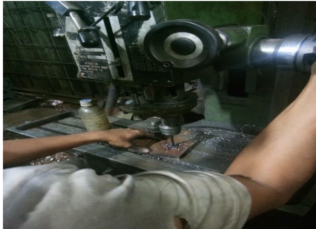
Gambar. 4.15. Proses Pengeboran Besi Plat
