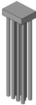
Gambar 4.23: Item Permodelan Pekerjaan Pilecap
