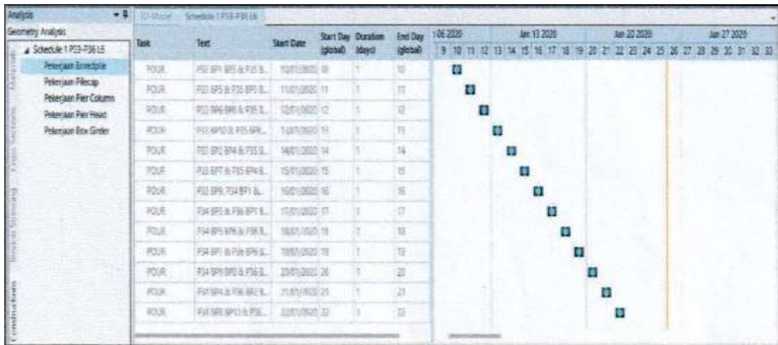
Gambar 4.16: Tampilan Penjadwalan Borepile dengan BIM
