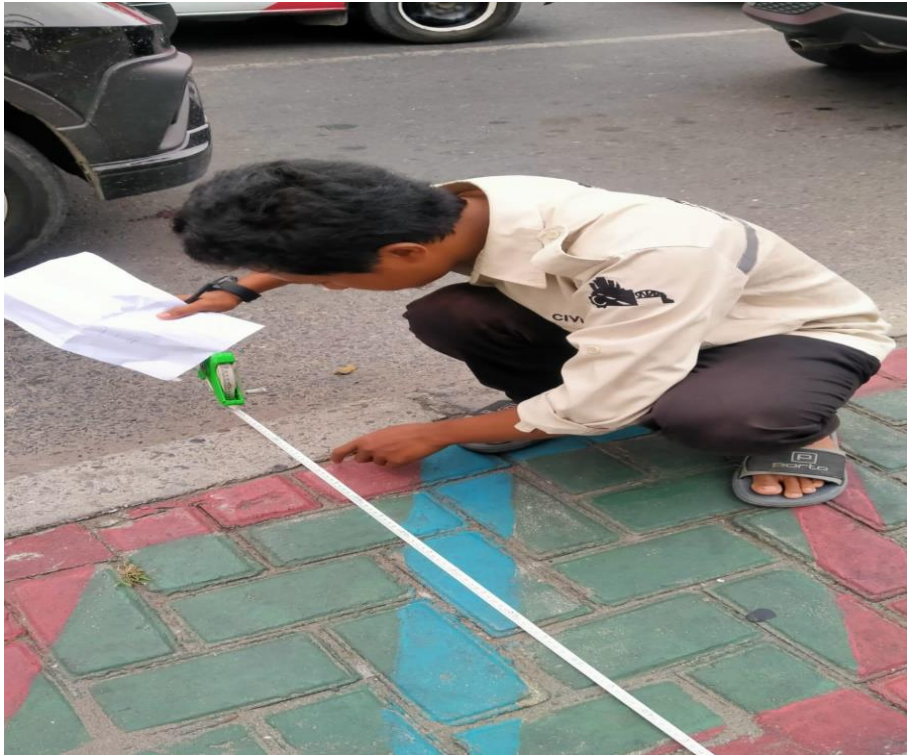
Gambar L.1.1 : mengukur median jalan
