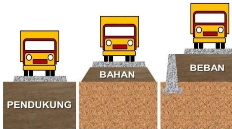
Gambar 2.1 : Peran tanah pada bangunan.
