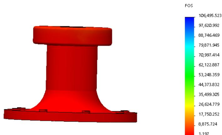
Gambar 4.17: Faktor Keamanan (*Factor of safety*) *Bollard* tipe Bitt.
