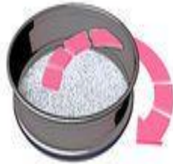
Gambar 2.7 Skema ayakan gerakan horizontal (Arilkusnanto, 2017)
