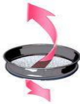
Gambar 2.6 Skema ayakan dengan gerakan melempa (Arilkusnanto, 2017)
