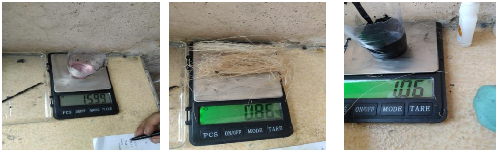
Gambar 4.2 Menimbang resin dan katalis, serat pelepah pisang dan serbuk arang cangkang kelapa sawit
