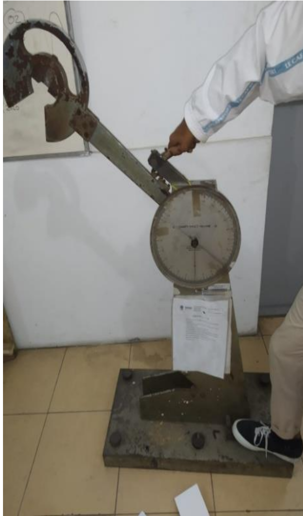
Gambar 3.17 Alat Uji Charpy
