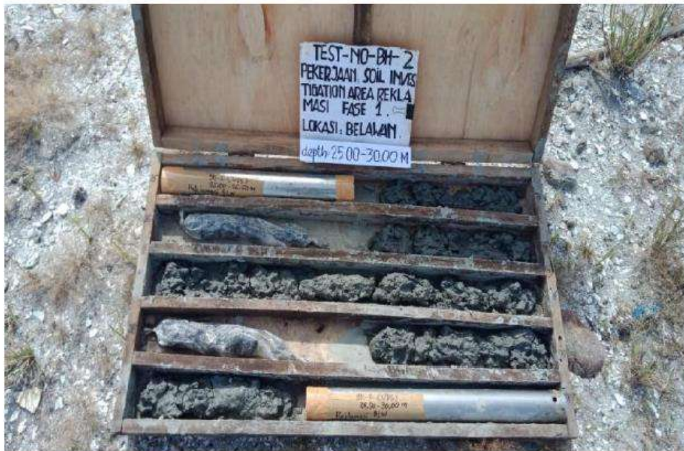
Sample Dalam Core Box BH-2 Laut ( 25.00 - 30.00 M )
