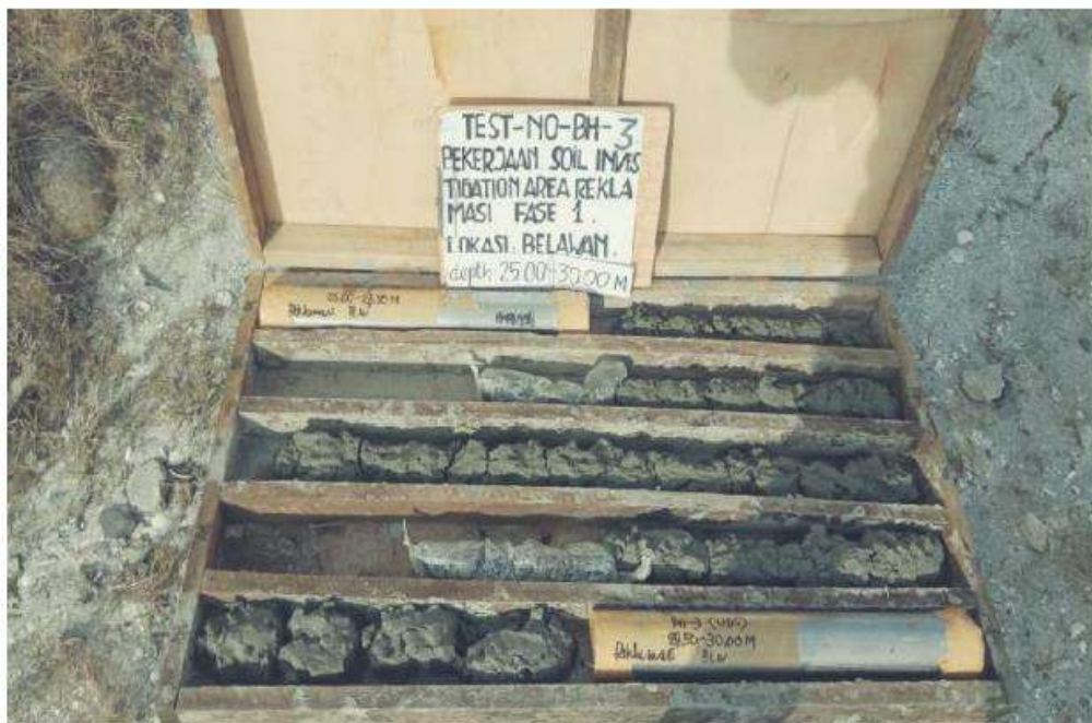
Sample Dalam Core Box BH-3 Laut ( 25.00 - 30.00 M )
