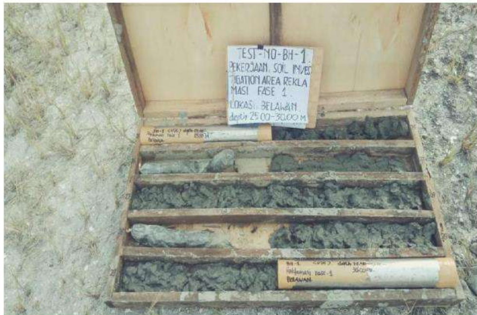
Sample Dalam Core Box BH-1 Laut ( 25.00 - 30.00 M )
