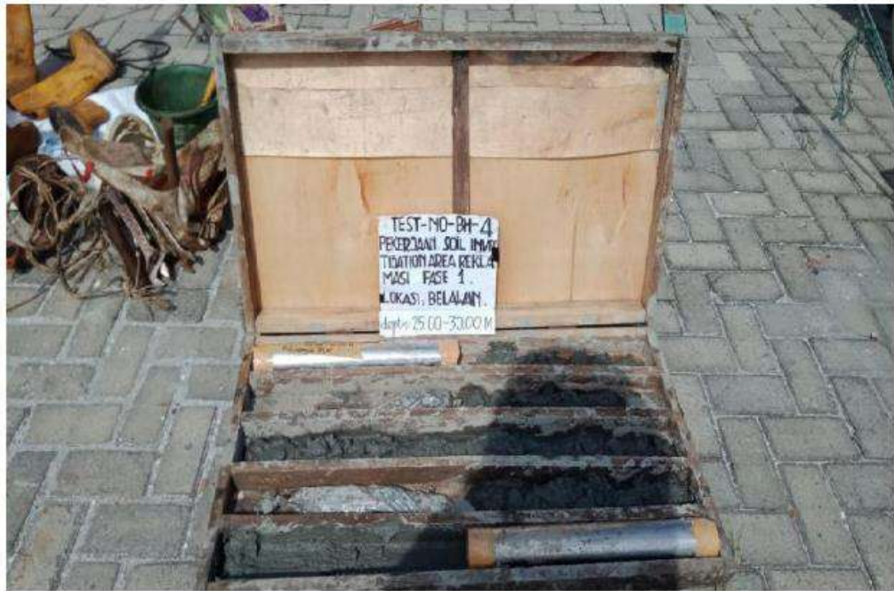
Sample Dalam Core Box BH-4 Laut ( 25.00 - 30.00 M )
