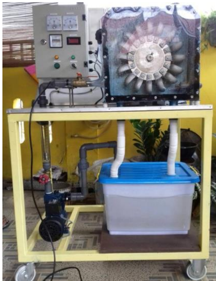
Gambar 2.2 Gambar Turbin Pelton(Syarif., 2019)
