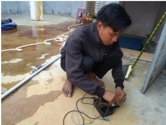
Gambar 4.4 menghubungkan sensor DS18B20 ke arduino UNO R3
