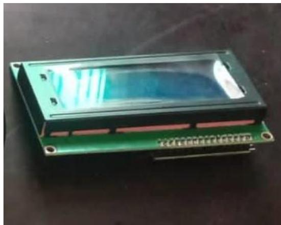
Gambar 3.6 *Lcd 20x4*
