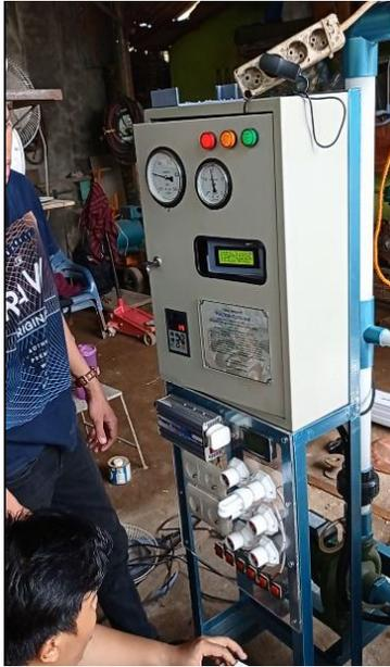
Gambar 3.15 Menghubungkan turbin pelton ke arus listrik
