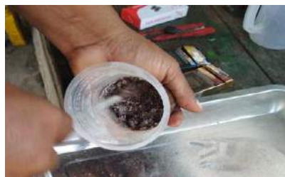
Gambar 3.6 Pengadukan pengikat (resin) dan filler serbuk cangkang
