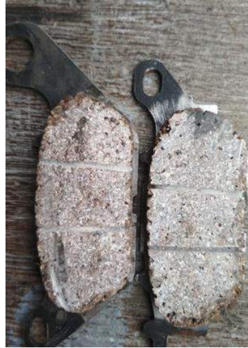
Gambar 4.13 Bahan sampel dengan mess 14
