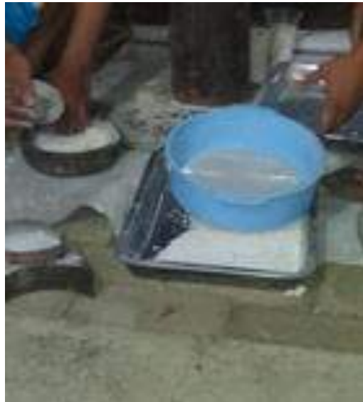
Gambar 3.3 Cangkang kerang ditumbuk dan disaring
