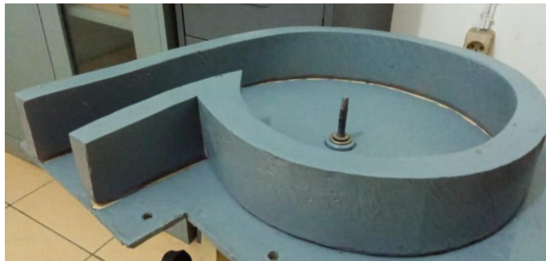
Gambar 4.10 Penyusutan Ukuran Dinding Blower
