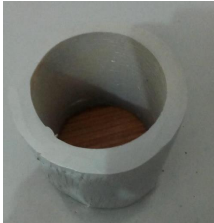
Gambar 4.11 Penyusutan Ukuran Dinding Blower
