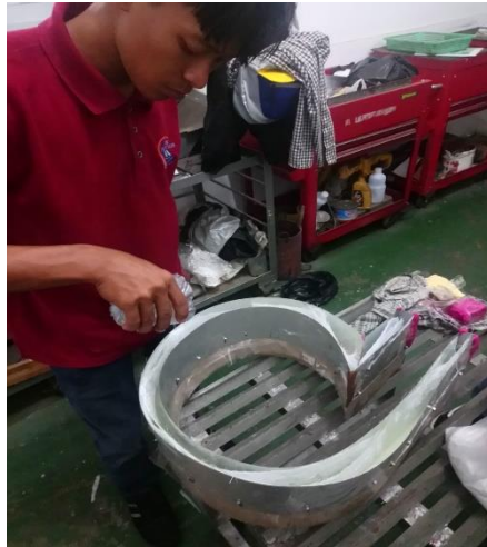
Gambar 4.5 Menuang resin kedalam cetakan
