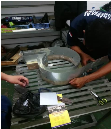
Gambar 4.6 Melepaskan resin dari cetakan
