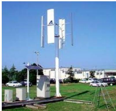
Gambar 3.5 Turbin Angin Vertikal
