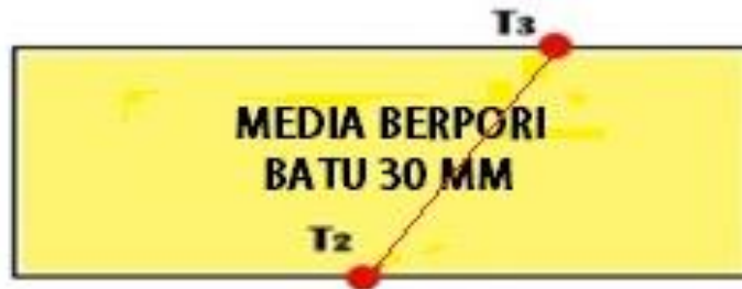
Gambar 4.3 Perpindahan panas konduksi pada saluran dengan penambahan porous media batu tinngi 30 mm
