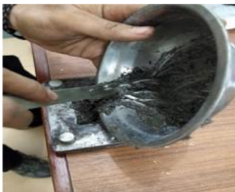
Gambar 3.23. Meratakan Adonan Pada Cetakan
