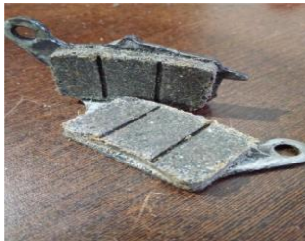
Gambar 3.25. Kampas Rem Selesai Proses Kompaksi
