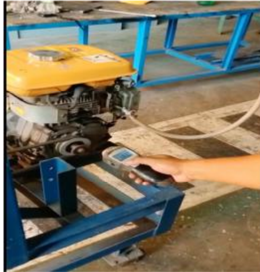
Gambar 2.29. Mengukur Rotasi Mesin Menggunakan Tachometer
