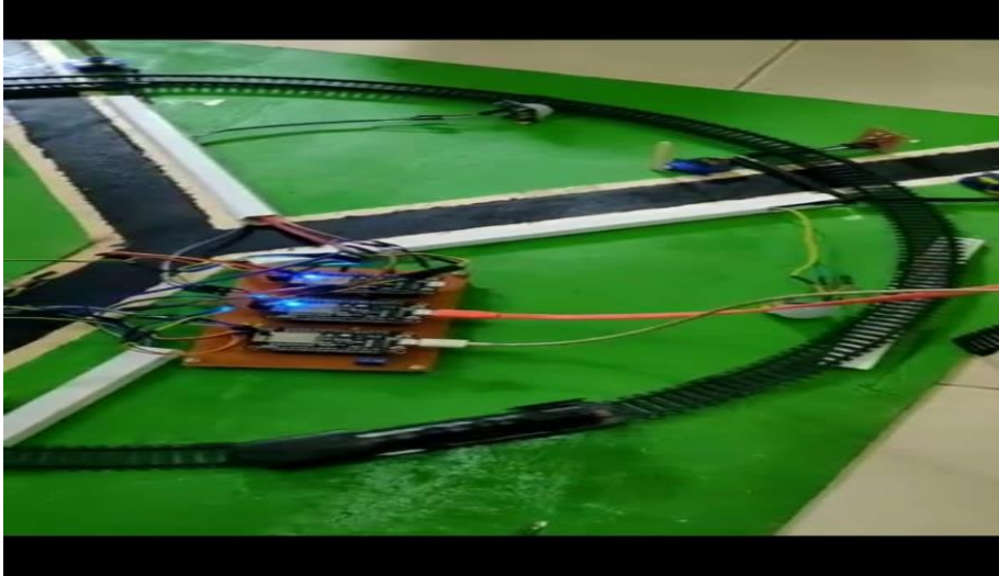
Gambar 4.9. Sumber baterai Dihubungkan dengan Sistem Kontrol IoT
