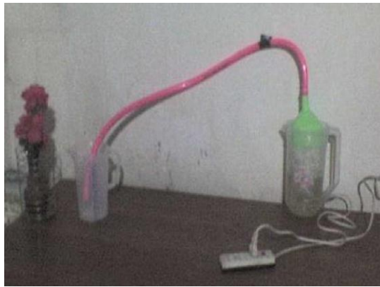
Gambar 2.4. Alat destilasi menggunakan Heater
