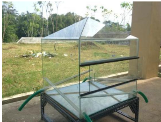
Gambar. 2.2. Alat destilasi energi surya penutup bentuk limas
