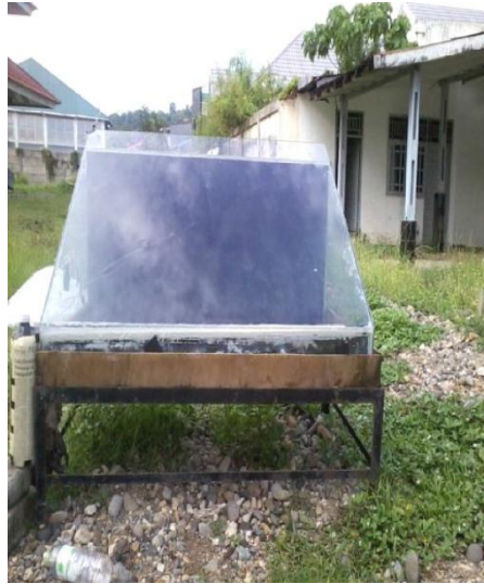
Gambar. 2.1. Alat destilasi energi surya penutup bentuk datar
