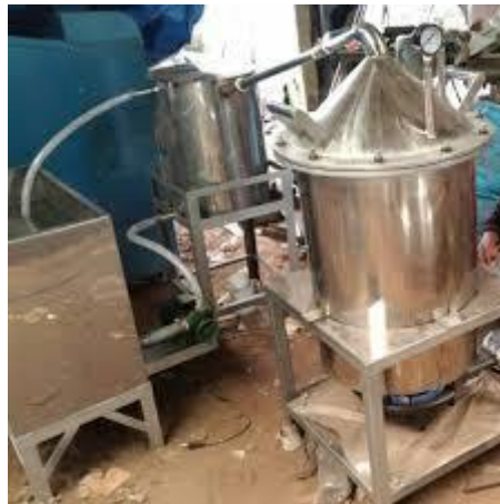
Gambar. 2.3. Alat destilasi menggunakan energi fosil
