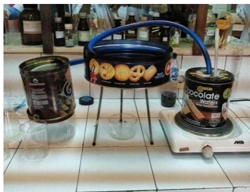
Gambar 2.5. Alat destilasi menggunakan kompor listrik
