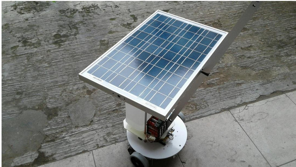
Gambar 4. 1. Rancangan sistem PLTS untuk suplai arus pada robot.
