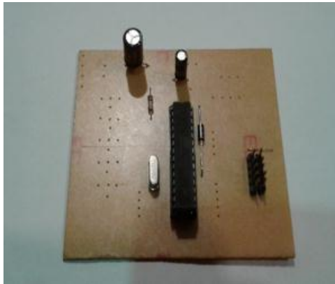
Gambar 3.6 Rangkaian mikrokontroler Atmega 8 sebagai kontrol charger.
