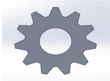
Gambar 4.3 Hasil desain roda gigi
