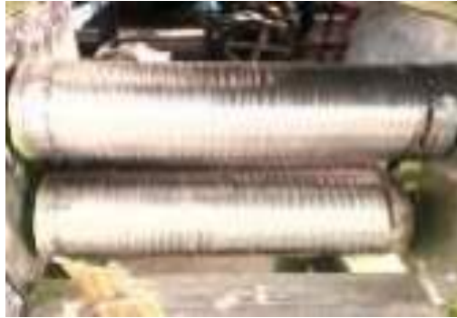
Gambar 2.2 Mesin peras tebu dua roll (Sumber: Harun Doe, Yunita Djmalu, Burhan Liputo, 2016)
