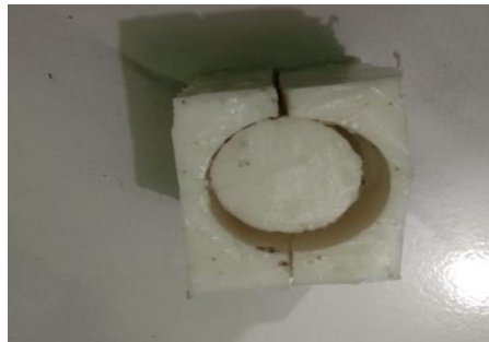
Gambar 3.23. Mal Cetakan Untuk Pembuatan Pipa
