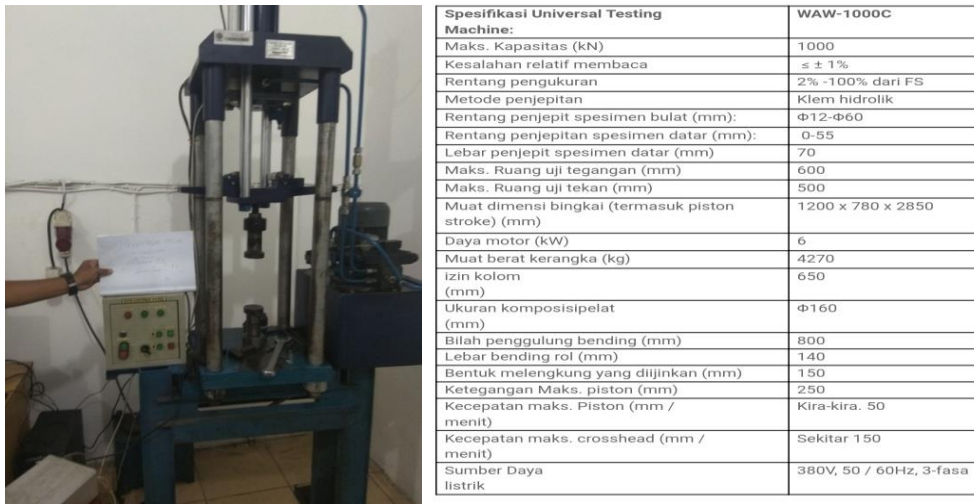
Gambar 3.1. Alat Uji Kekuatan Tekan
