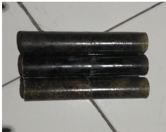
Gambar 3.25. Hasil Pipa Yang Terbuat Dari Hasil Pemanfaatan Limbah Serat Daun Nanas dan Serbuk Cangkang Kelapa Sawit.
