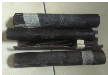
Gambar 3.27 Spesimen Setelah Diuji Kekuatan Tekan
