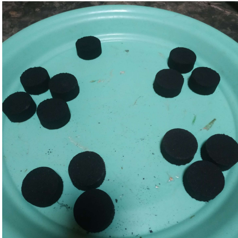
Gambar 7: Pelepasan briket dari cetakan dan penjemuran selama 3 hari Pengujian Berat Briket sekaligus uji kadar air
