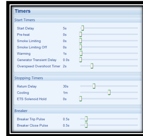
Gambar 5. 17 Pengontrolan Timers pada Modul Deep Sea Elektronik 3110
