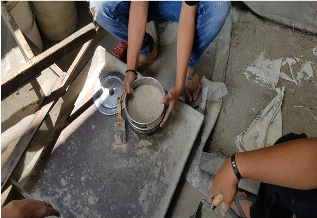
Gambar L.3: Proses penyaringan agregat
