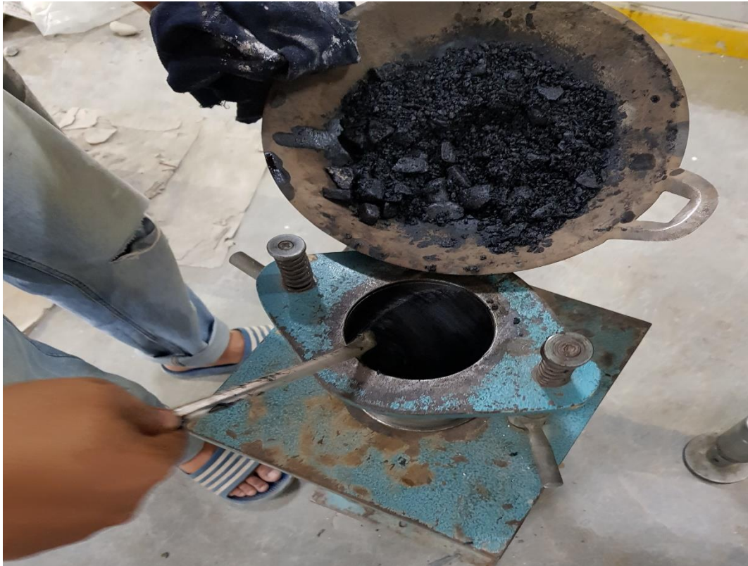
Gambar L.7: Pembuatan benda uji.
