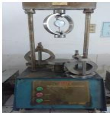
Gambar 2.1: Alat pengujian Marshall (Maulana, 2019)
