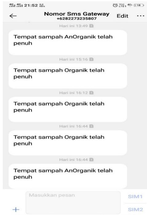
Gambar 4.9 Hasil dari sms gateway mengirim pesan ke smartphone dalam bentuk sms
