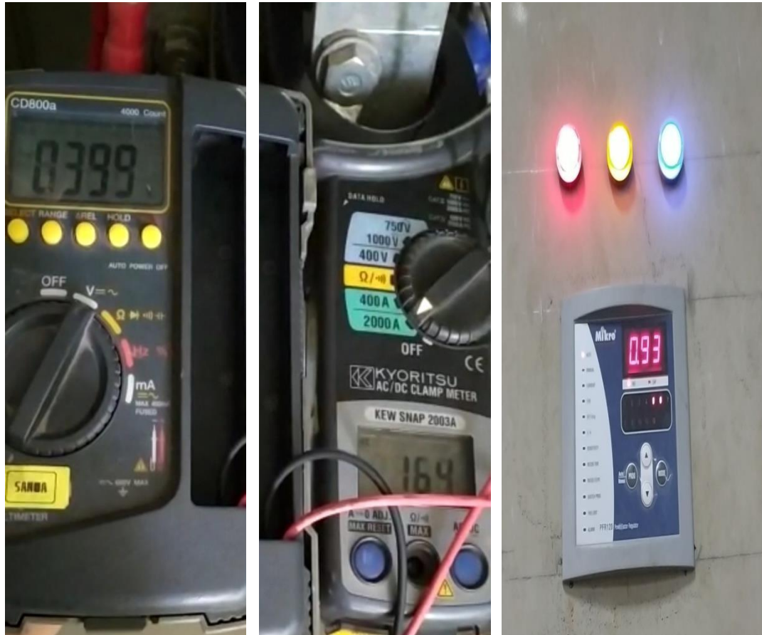
Gambar 4.8 Hasil percobaan motor kompresor tipe G.A 250 KW menggunakan kapasitor pada posisi unload atau belum berbeban
