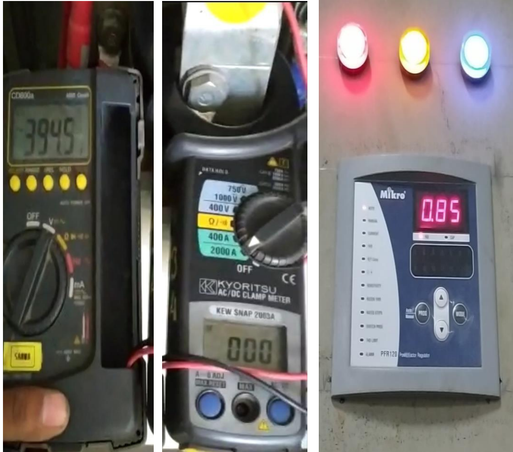
Gambar 4.1 Hasil percobaan motor kompresor tipe G.A 250 KW tanpa menggunakan kapasitor pada posisi off
