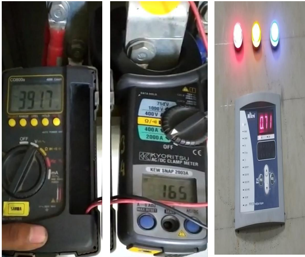
Gambar 4.3 Hasil percobaan motor kompresor tipe G.A 250 KW tanpa menggunakan kapasitor pada posisi Unload atau belum berbeban
