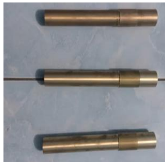
Gambar 4.8 Hasil Spesimen Yang Diuji Dengan Kecepatan 720Rpm
