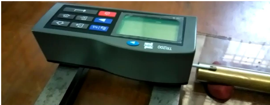
Gambar 3.8 pengukuran tingkat kekasaran
