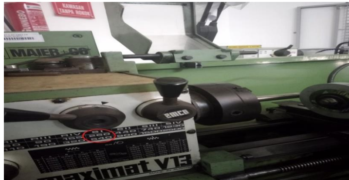
Gambar 4.4 Pengujian Dengan Kecepatan 540Rpm
