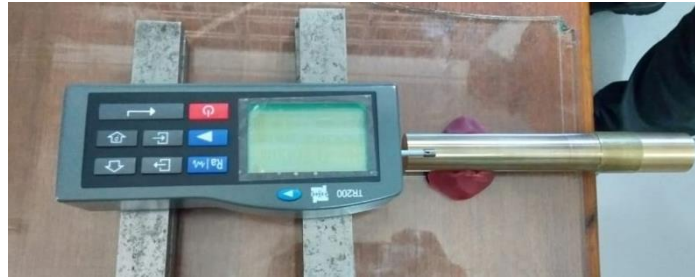
Gambar 4.10 Pengujian Material kuningan Dengan Menggunakan Roughnes Tester
