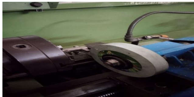
Gambar 4.6 Melakukan Pengasahan Dengan Dresser
