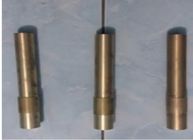
Gambar 4.7 Hasil Spesimen Yang Diuji Dengan Kecepatan 540 Rpm
