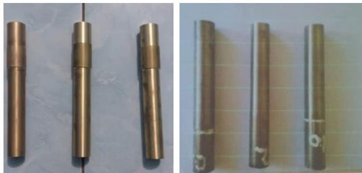
Gambar 4.18 Spesimen yang sudah dilakukan penggerindaan pada kecepatan 540 rpm dan 720 rpm.
