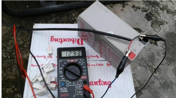
Gambar 4.10. Pengukuran tegangan pada pengujian baterai 12V
