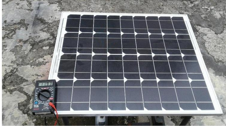
(b) Pengukuran tegangan dengan Voltmeter
