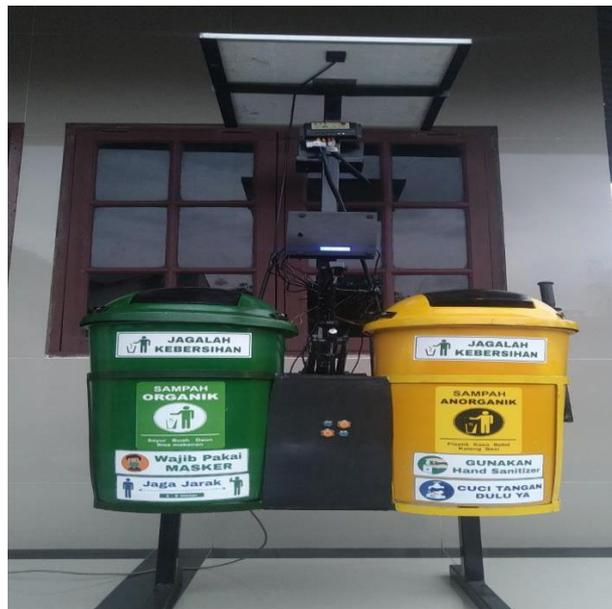
Gambar 4.1 Foto rancangan sistem PLTS pensuplai arus pada tempat sampah otomatis.
