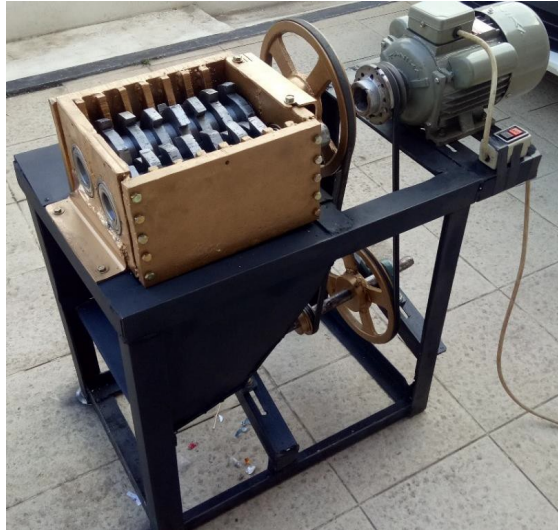
Gambar 2.7. Mesin penghancur kaleng aluminium
