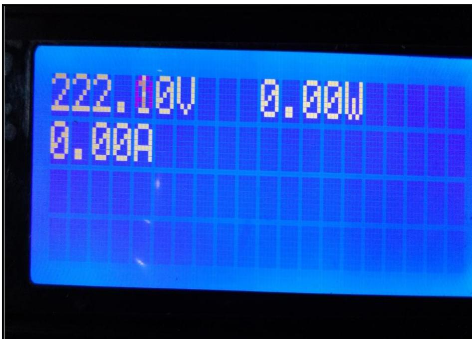
Gambar 4.7 Tampilan LCD Pengujian Sensor PZEM-004T Dengan LCD
