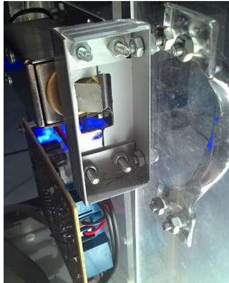
Gambar 4.11. Solenoid ( Off ) Menutup Pengunci Pintu
