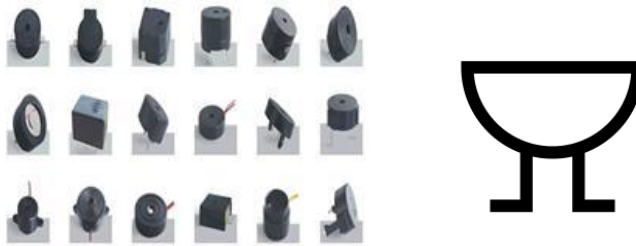
Gambar 2.12 Bentuk fisik dan symbol buzzer
