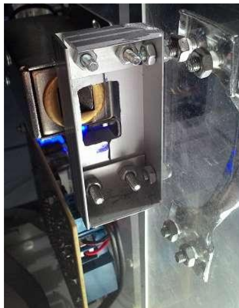
Gambar 4.10. Solenoid (On) Membuka Pengunci Pintu
