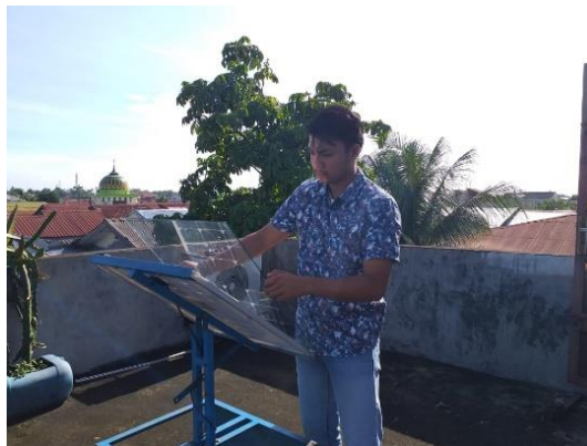
Gambar 3.25 pemasangan lapisan kaca
