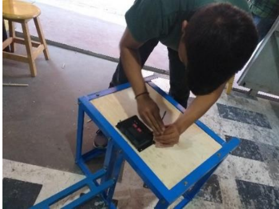
Gambar 3.20 Pemasangan Charger Contoler
