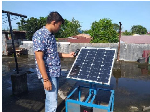
Gambar 3.27 Mengukur intensitas radiasi matahari
