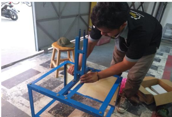
Gambar 3.24 Memasang Tiang penyangga Panel
