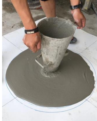
Gambar 3.9 Pengujian Slump Flow
