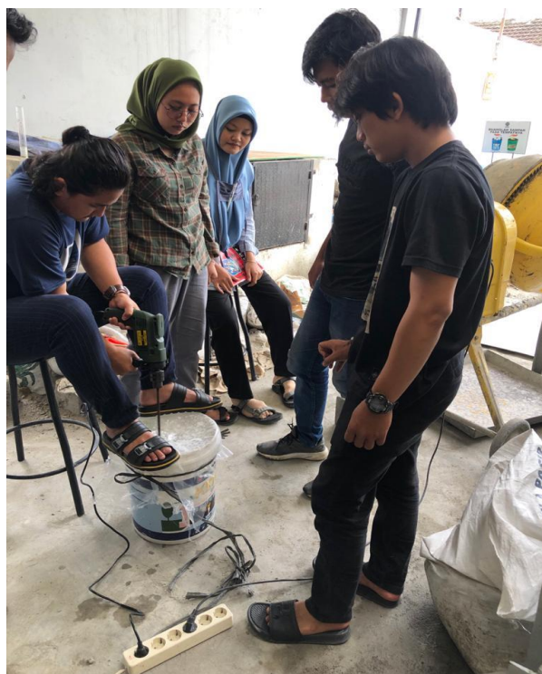
Gambar L.4: Proses Pembuatan Foam Agent
