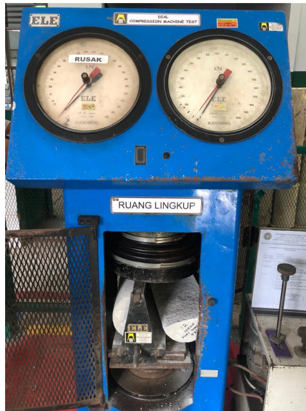
Gambar 3.13 Pengujian Kuat Tarik Beton
