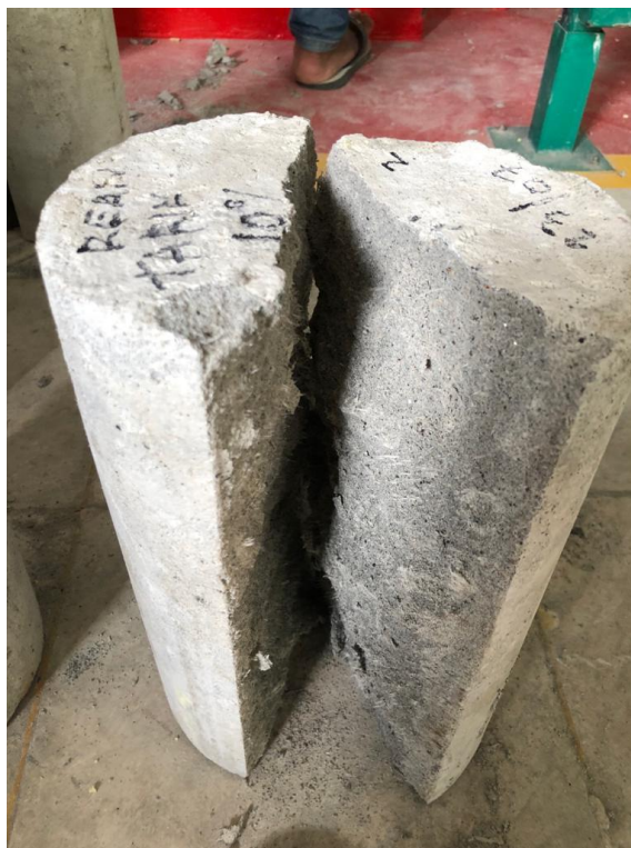
Gambar L.2: Hasil Pengujian Kuat Tarik
