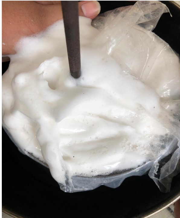
Gambar L.5: Busa Foam Agent Pada Campuran Beton
